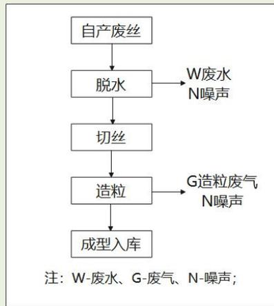
图 2-3 废丝资源化利用生产工艺流程及产污环节图
